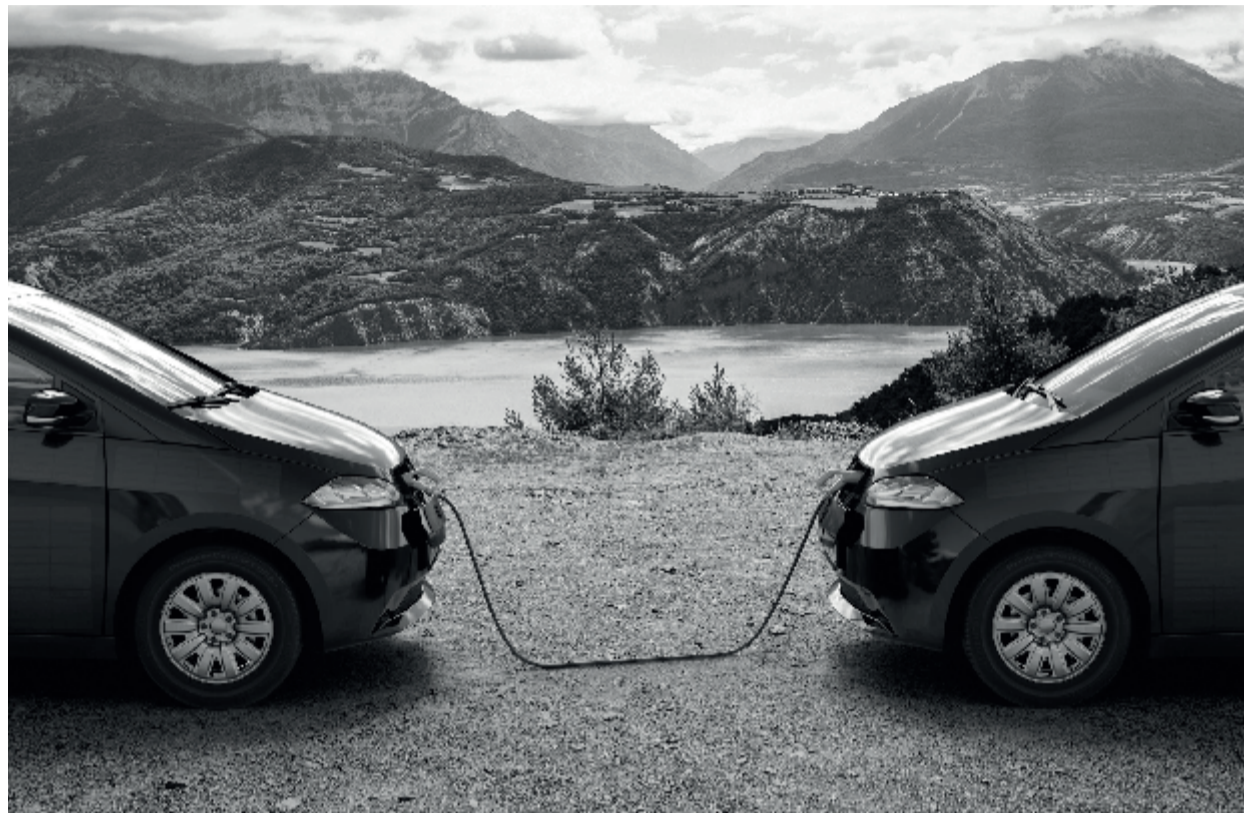
▲ Solarzellen in der Karosserie laden die Batterie des neuen »Sion«, der Strom kann auch an andere Elektroautos weitergegeben werden. Im Bild zwei Prototypen. Foto: Sono Motors GmbH
